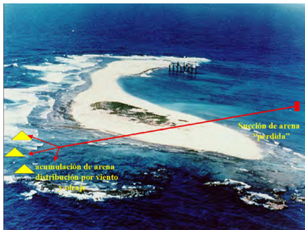
Figura 39. Esquema de succión por motobombas de arena y agua desde sotavento y distribución en la playa de barlovento mediante una manguera flexible.
